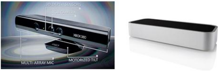
图 10 Kinect 和 LeapMotion 手势控制器
