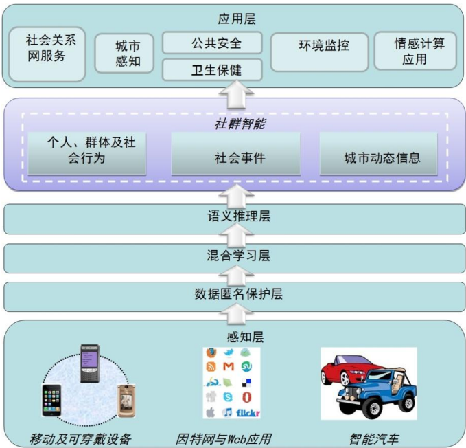
图 14 群智感知计算体系架构
